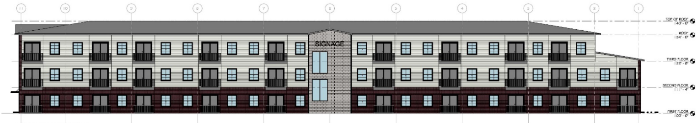
2 EAST EXTERIOR ELEVATION SCALE: 1/8" = 1'-0"
